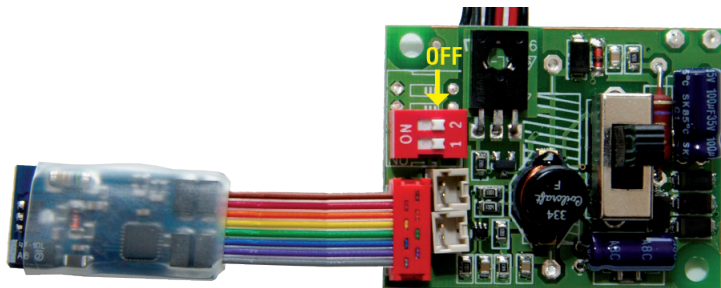
Abbildung 1: eMOTION 8FL an LGB® Funktionsdecoder mit Digitalschnittstelle Illustration #1: eMOTION 8FL with LGB® Function Decoder + digital interface
